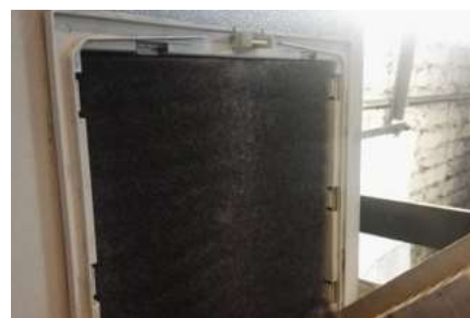
Fig. 4 Essai sur site avec un filtre en fibres mêlées non-tissées à texture progressive
