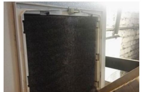
그림 4 분쇄 섬유 필터(chopped-fibre filter)를 사용한 현장 테스트
