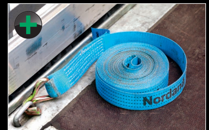
Im Fahrzeug integrierte Zurpunkte zur Ladungssicherung.
