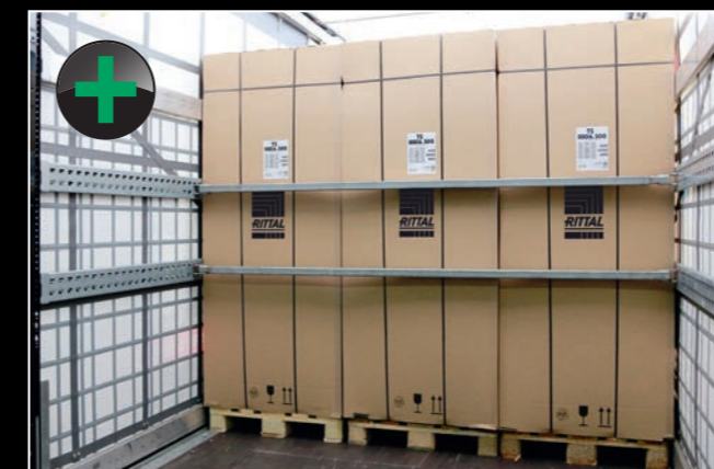
Sperrbalken als vorgeschriebene Ladungssicherung am Heckabschluss.
