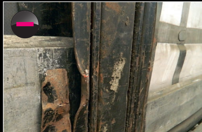
Beschädigung an den Rungen und an der Fahrzeugplane sind nicht zulässig.
