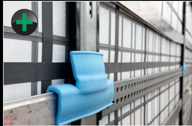
Schutzpolster an den Rungen. Beschädigungsfreie Einstecklaschen zur Vermeidung von Transportbeschädigungen durch Reibung.
