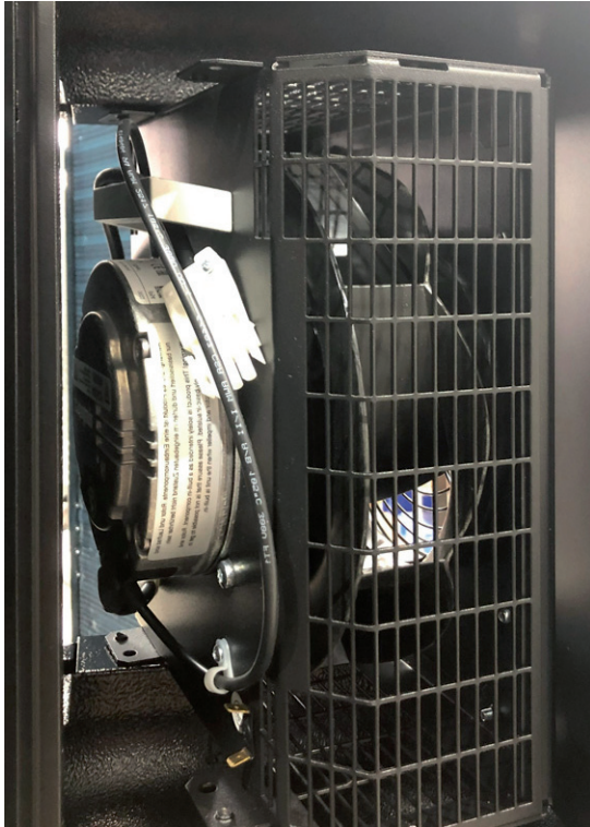
Fig. 43: Rotated fan module in fan tray
