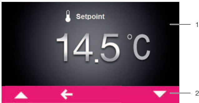
Imagen 28: Pantalla para modificar el valor de un parámetro
