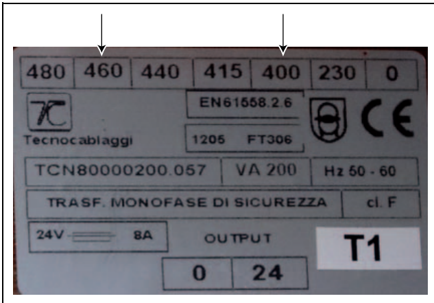
Fig. 21 : raccordement du transformateur
