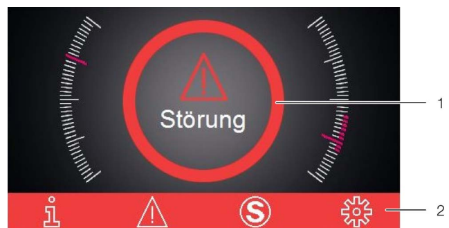
Abb. 19: Bildschirm bei Auftreten einer Störung
