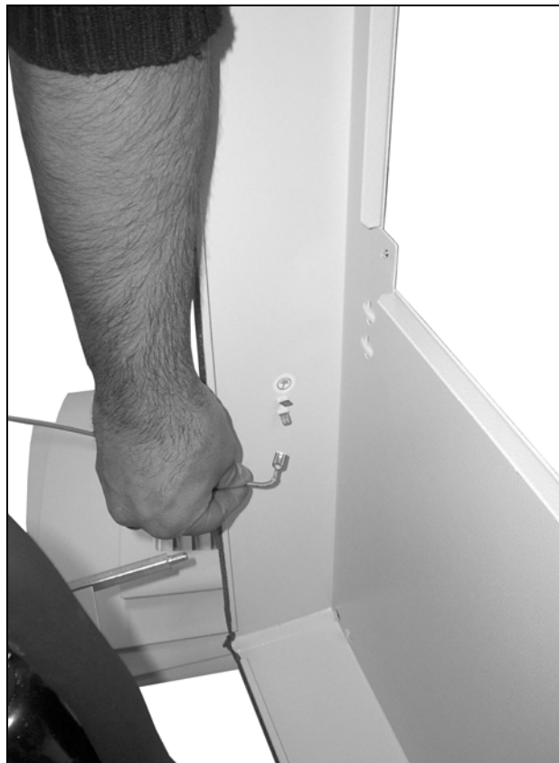
Рис. 73: Отсоедините кабель заземления
