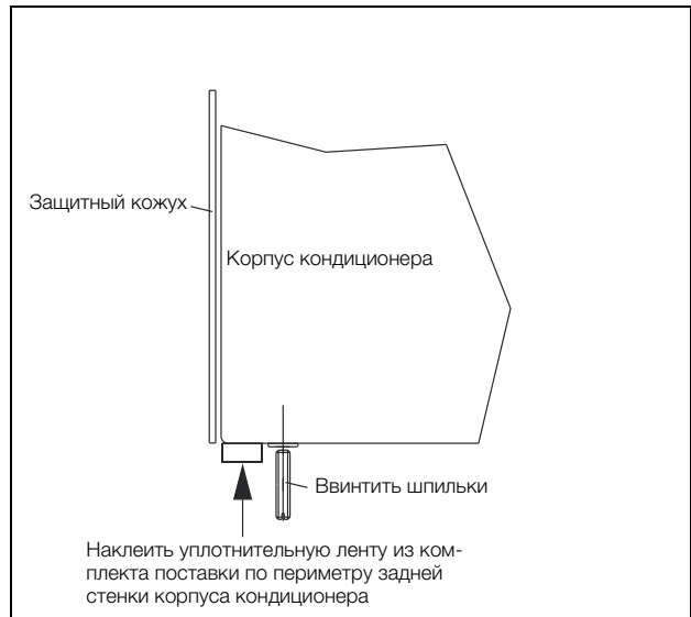
Рис. 77: Подготовка кондиционера к монтажу (вид сверху)
