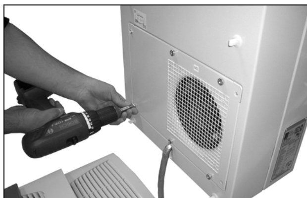
Рис. 41: Выкрутите четыре винта крепления панели вентилятора конденсатора к кожуху корпуса
