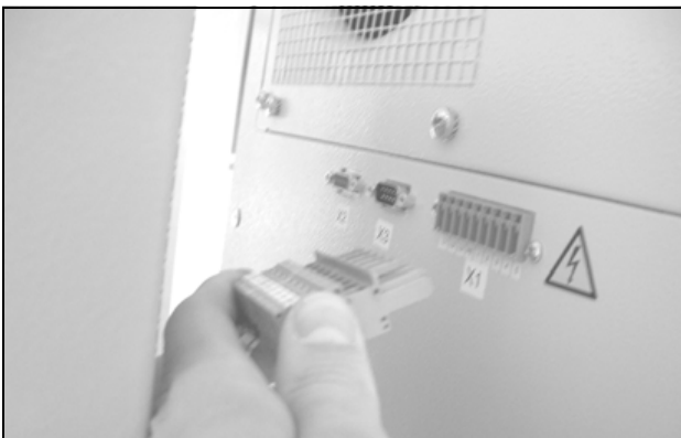
Рис. 34: Отсоедините штекер электропитания
