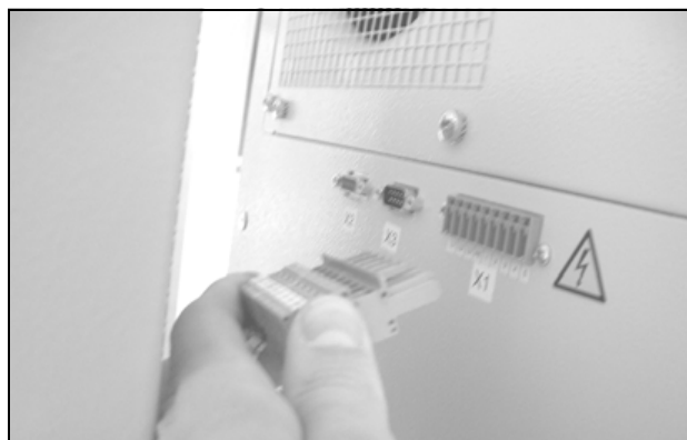
Рис. 53: Отсоедините штекер электропитания
