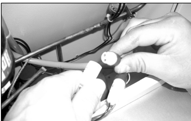
Рис. 67: Разъедините штекеры линии электропитания и контроля вентилятора конденсатора
