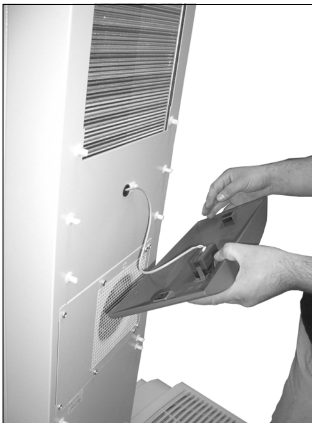
Рис. 59: Снимите среднюю панель
