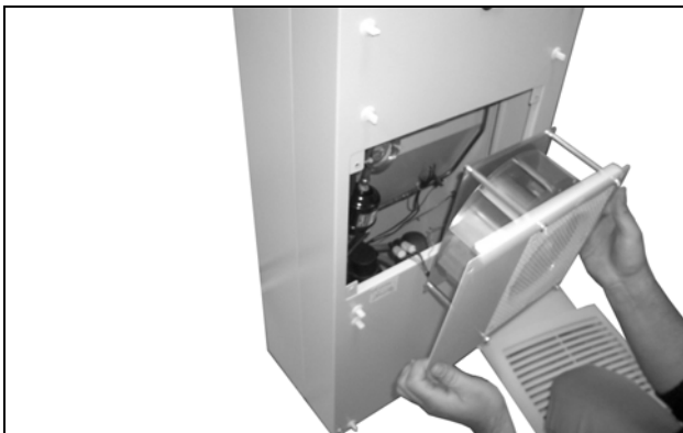
Рис. 64: Извлеките панель вместе с вентилятором конденсатора
