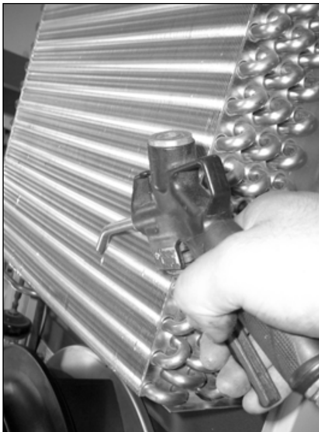
Рис. 51: Продуйте конденсатор сжатым воздухом
