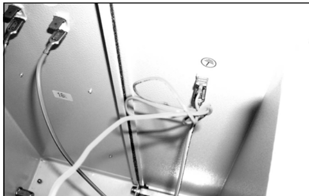
Рис. 68: Вентилятор конденсатора также соединен с корпусом кабелем заземления
