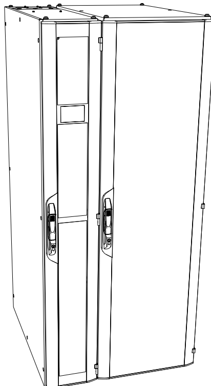
Obr. 7: LCP Rack se serverovou skříní
