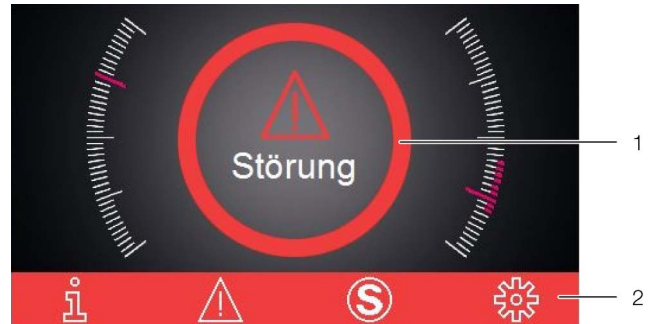
Abb. 44: Bildschirm bei Auftreten einer Störung
