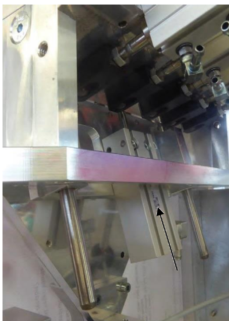
图 32: 端头分离刀气缸
