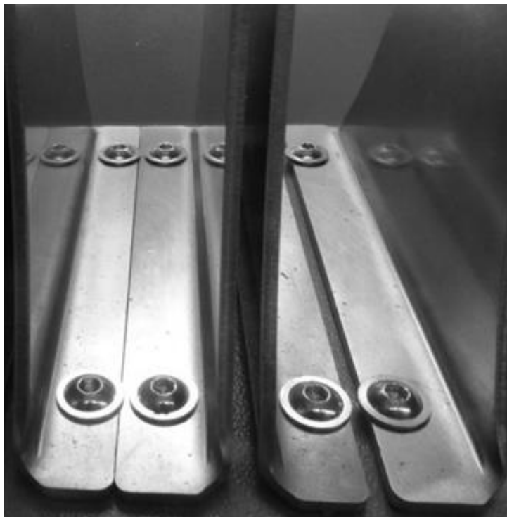
图 7: 导线卷支架 (8 mm 长: 左侧, 10 mm 长: 右侧)
