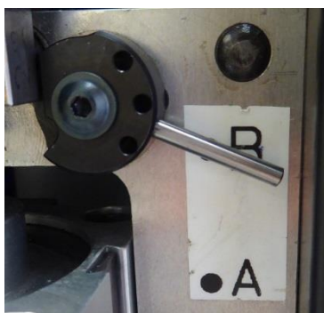
图 13: 绞线固定单元调整装置（已调整：B）
