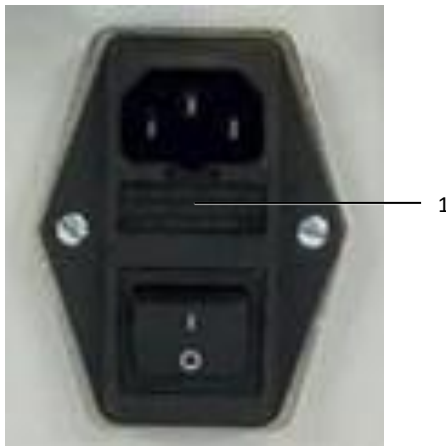
Rys. 36: Otwieranie skrzynki bezpiecznikowej
