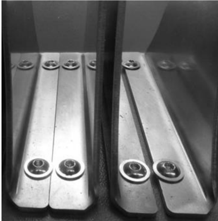
Fig. 7 : support de bobine (longueur 8 mm : à gauche, longueur 10 mm : à droite)
