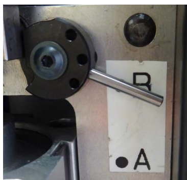
Fig. 13 : réglage de l'unité de fixation du fil toronné (réglé : B)
