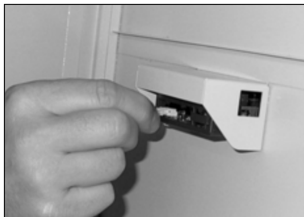
Afb. 29: Connector van het display losnemen
