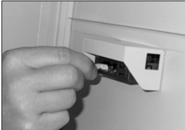
Afb. 15: Aansluitkabel display aansluiten
