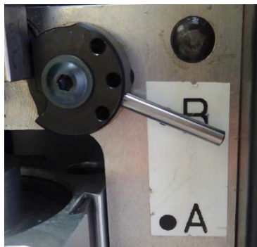
Bild 13: Inställning för trådfixering (inställd: B)
