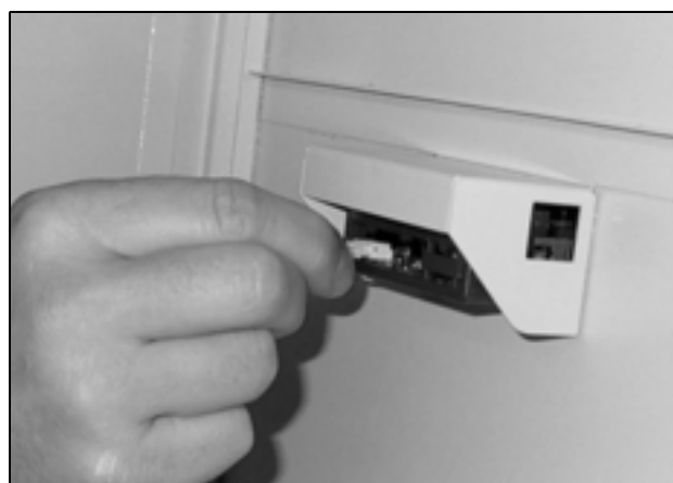
Fig. 29 : Ôter le connecteur de l'afficheur
