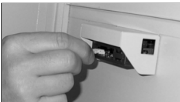
Fig. 15 : Brancher le câble de raccordement de l'afficheur
