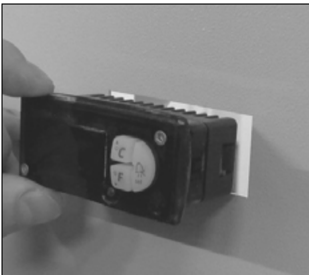
Fig. 10 : Insérer l'afficheur dans l'ouverture prévue sur la porte profilée
