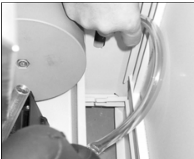
Fig. 9 : Faire sortir le tuyau d'écoulement de l'appareil
