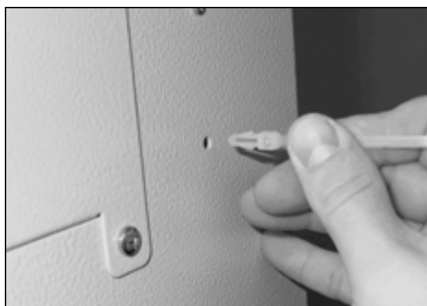
Fig. 18 : Mettre le collier de câblage en place à l'avant du module de refroidissement pour assurer la décharge de traction
