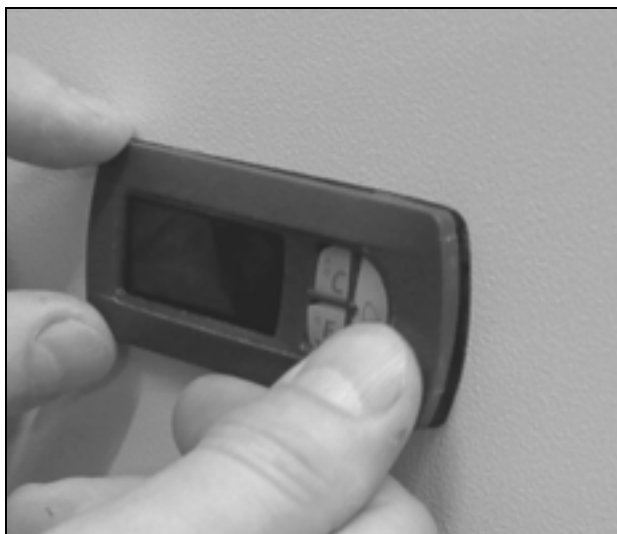
Imagen 12: Colocación de la tapa
