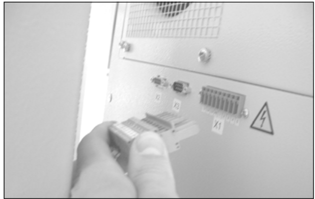
図38： 接続プラグを抜く
