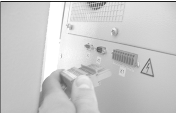
図57: 接続プラグを抜く
