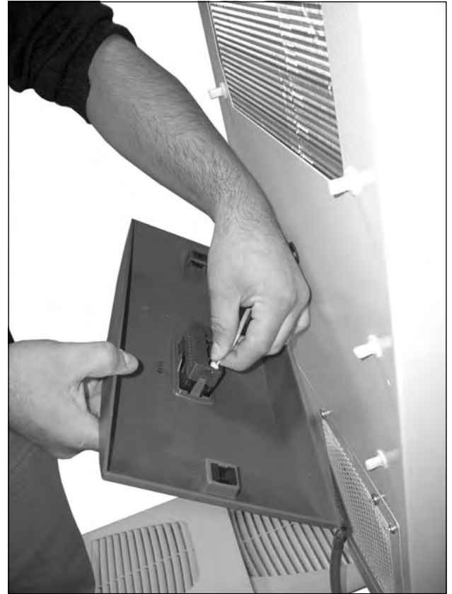
図42： モニターのプラグを抜く(1)
