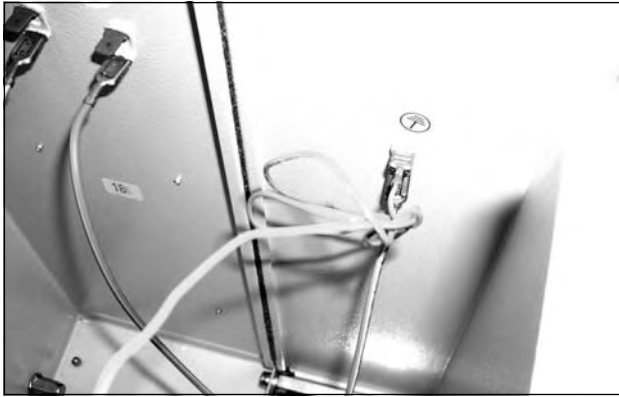
図 72: ファンのアースケーブルを外す (1)
