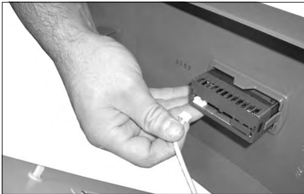
図64: モニターケーブルを引き抜く
