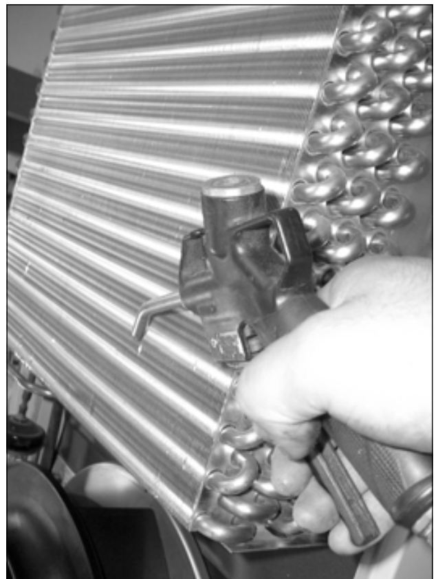
図55： ヒートエクスチェンジャー部分とコンプレッサールームの汚れを圧縮空気で吹き払う(1)
