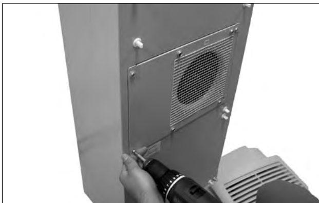
図67: 外部循環経路用ファンに付いている4個のネジを 外す
