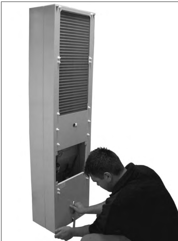
図 74: カバーに付いている4個のナットを外す
