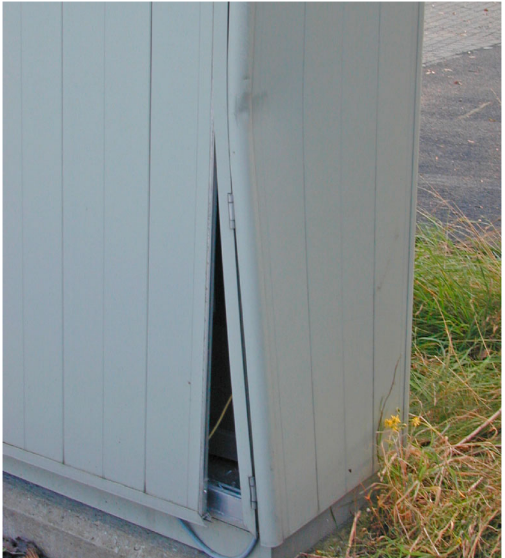
Abbildung 1: Verformtes Gehäuse nach Kräfteinwirkungen
