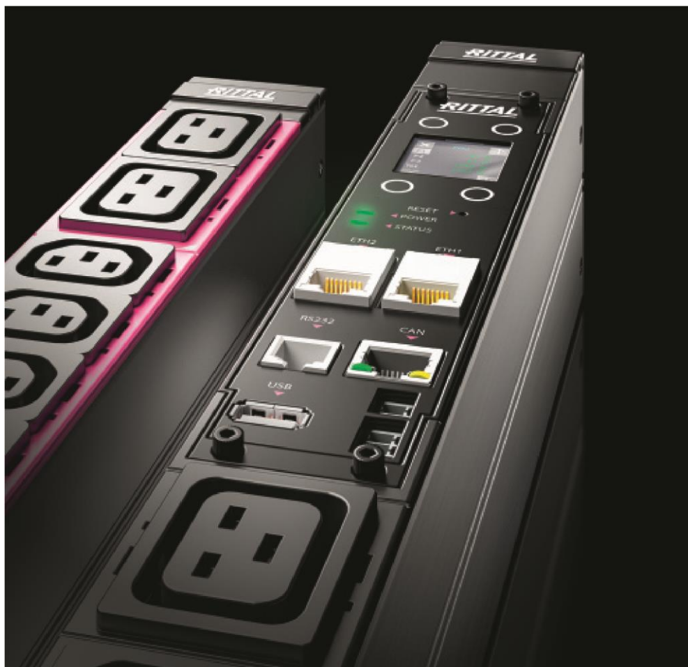
Ilustracja 4: Slim fit: cechą unikalną na rynku jest kompaktowa i wąska forma listw Rittal PDU. Dzięki temu można instalować PDU w przestrzeni między ścianą boczną a ramą montażową 19".
