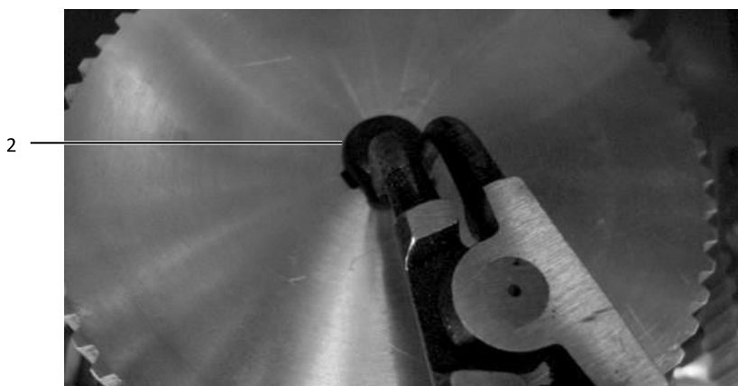
Obr. 10: Sejmутí pojistného kroužku
