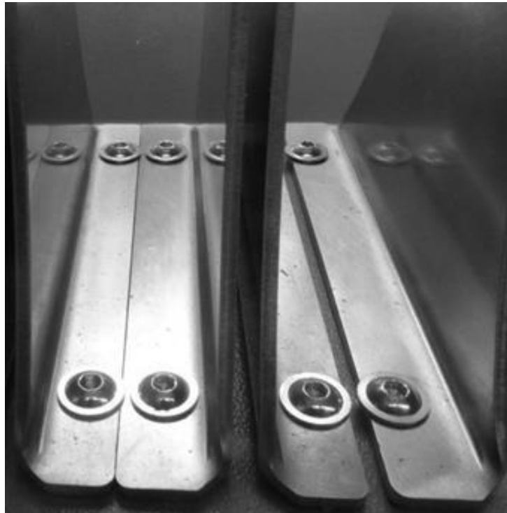
Afb. 5: Magazijnhouder (lengte 8 mm: links, lengte 10 mm: rechts)
