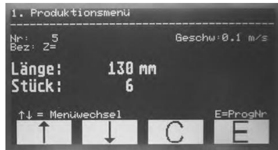
Fig. 3 : écran, affichage après la mise sous tension
