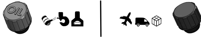
Abb. 3: Tausch der Verschlusschraube bzw. Belüftungsschraube (Darstellung beispielhaft)
