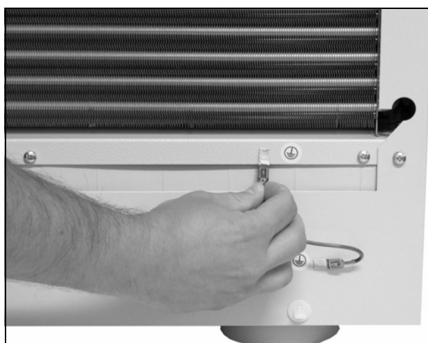
Rys. 25: Wyciąganie kabla uziemienia
