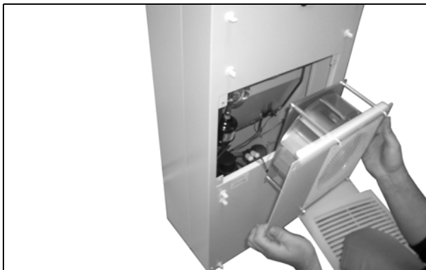
Fig. 64: Smontare il ventilatore del circuito esterno
