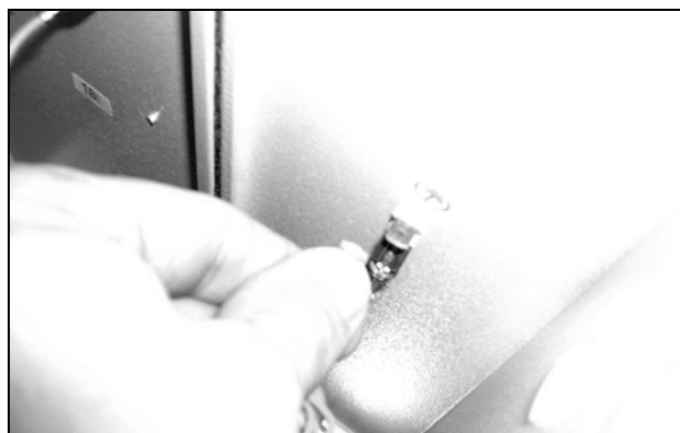
Fig. 69: Scollegare il cavo di massa del ventilatore (2)
