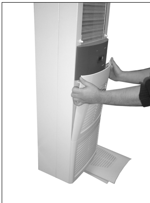
Fig. 57: Rimuovere la griglia di aerazione inferiore (1)
