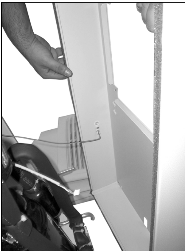
Fig. 72: Staccare il cavo di massa (1)
