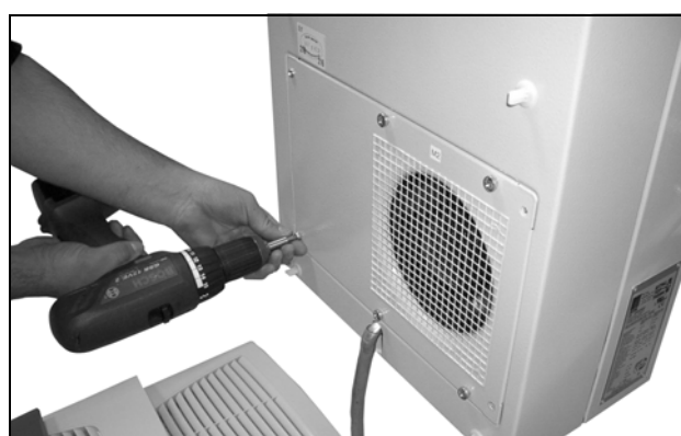
Fig. 41: Smontare il ventilatore del circuito esterno (allentare le quattro viti)
