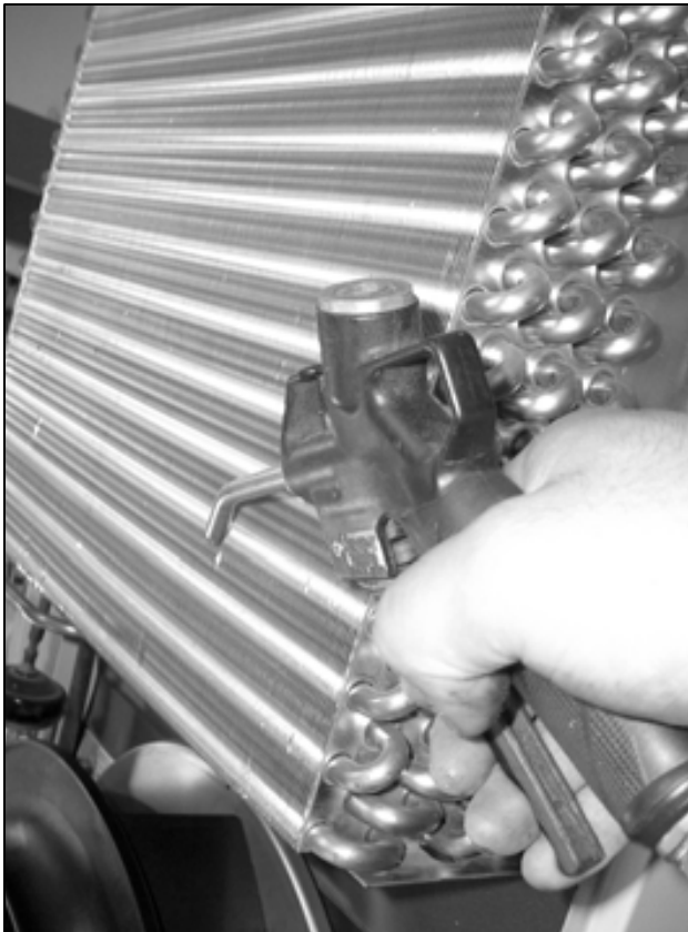
Fig. 75: Soffiare aria compressa sui tubi dello scambiatore di calore e nel vano compressore (2)
