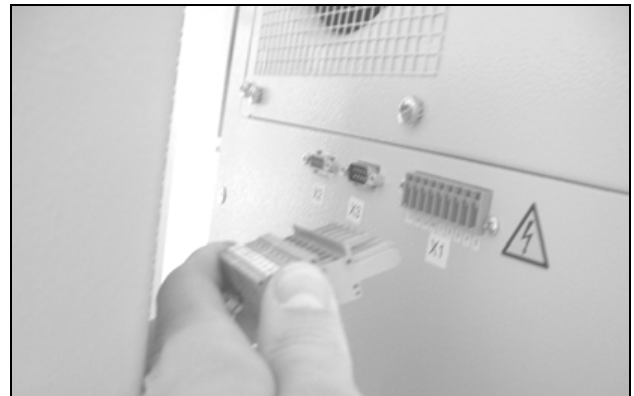
Fig. 53: Estrarre il connettore di alimentazione
