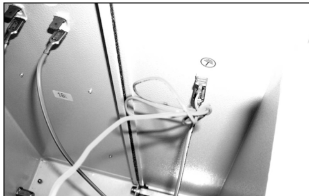
Fig. 68: Scollegare il cavo di massa del ventilatore (1)
