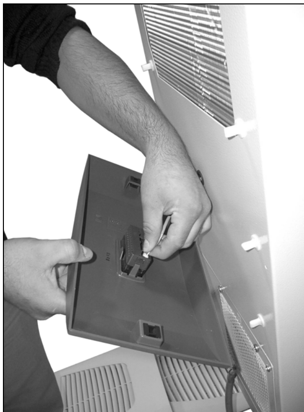
Fig. 38: Estrarre il connettore del display (1)
