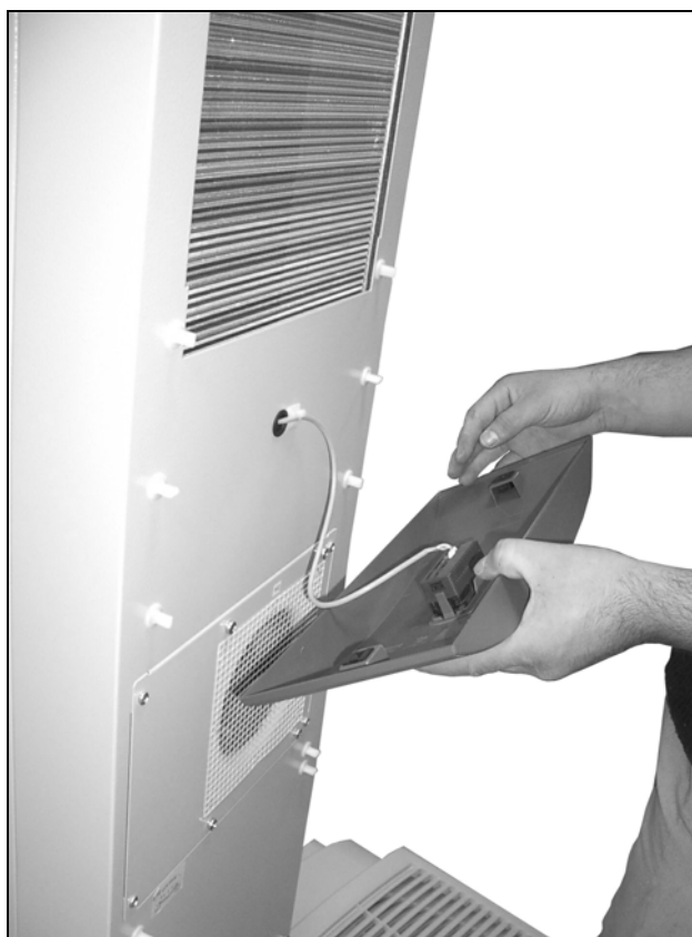
Fig. 59: Rimuovere la calotta
