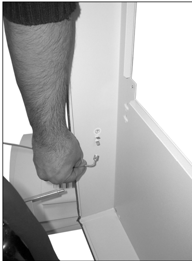
Fig. 73: Staccare il cavo di massa (2)
