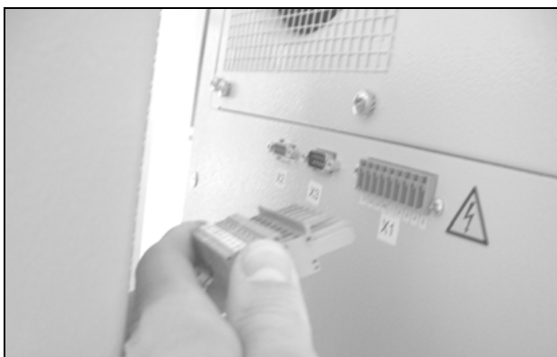
Fig. 34: Estrarre il connettore di alimentazione
