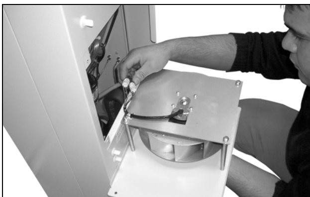
Fig. 65: Scollegare i connettori del ventilatore (1)
