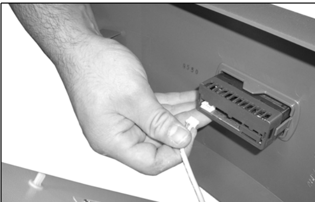
イラスト 60: ディスプレイ用ケーブルを引き抜く
