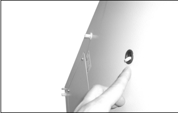
イラスト 46: ディスプレイ用ケーブルをケーブル引き込み口に押し込む
