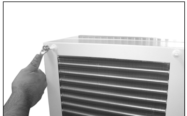
イラスト 44: カバーを取り外す (ナット 4 個を外す)
