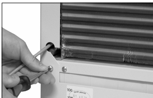
Afb. 26: Bevestigingsschroeven van de afdekkap verwijderen (vier schroeven losdraaien)
