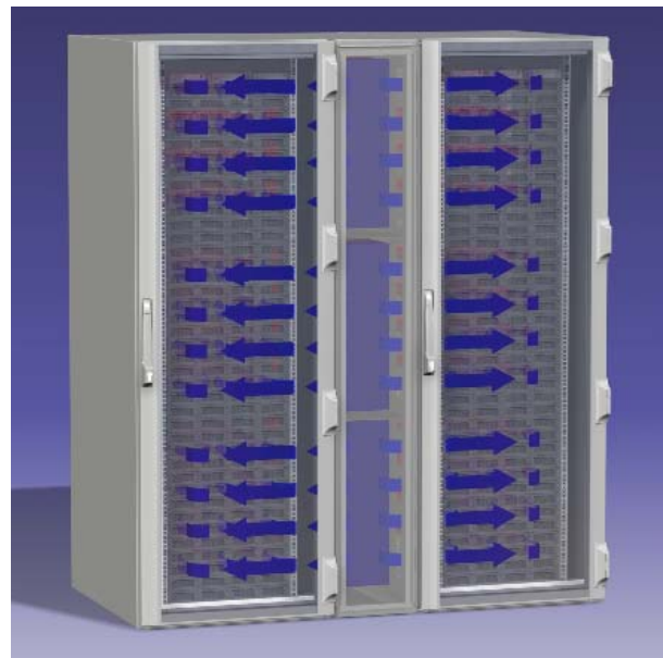
Abb. 8: LCP Rack an zwei Serverschränken
