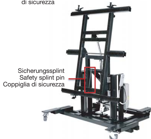
3.3 Montagetisch 200 EN: Position des Sicherungssplints Assembly frame 200 EN: Position of the safety split pin Tavolo di montaggio 200 EN Posizione della coppiglia di sicurezza
