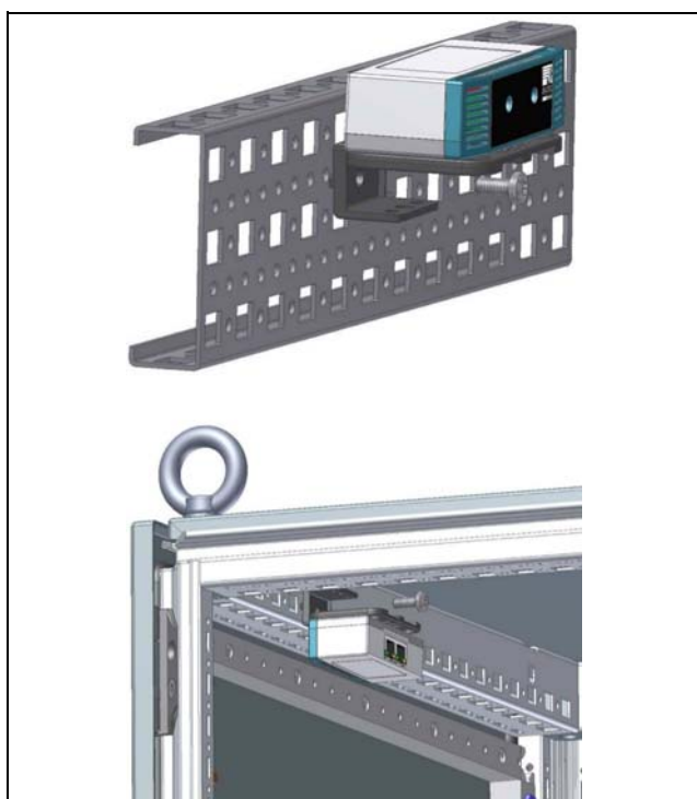
Рис. 5: Крепление датчика в шкафу или IT-стойке
