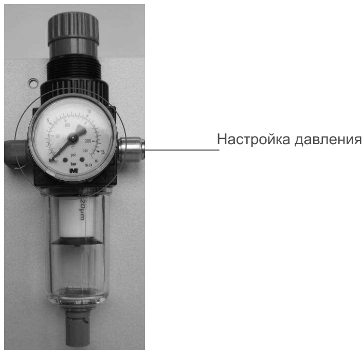
Рис. 10: Блок обслуживания сжатого воздуха
