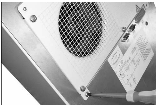
Рис. 28: Удаление крепежных винтов кожуха вентилятора
