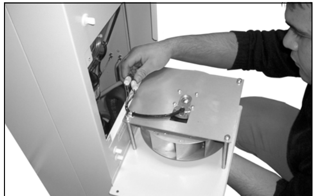
Abb. 65: Steckverbindungen des Lüfters abziehen (1)
