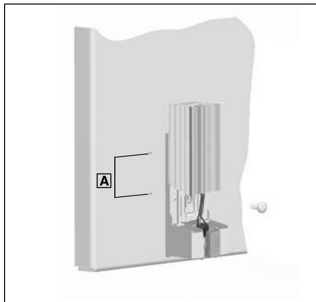
Imagen 3: Fijación atornillada sobre placa de montaje
