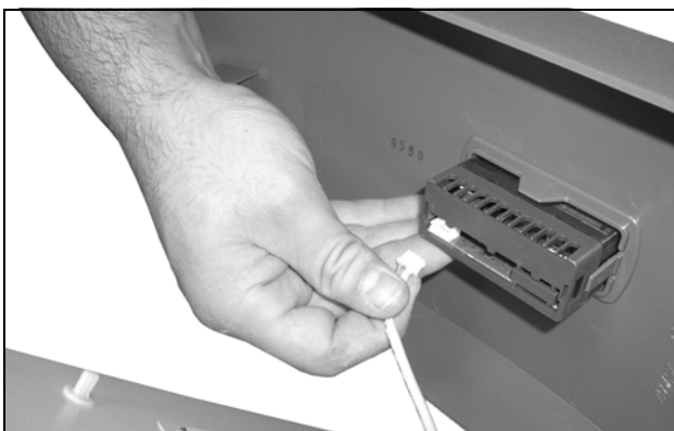
Obr. 60: Odpojení kabelu displeje
