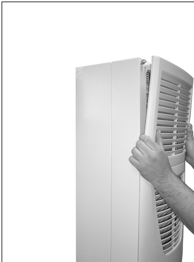
Obr. 55: Odstranění horní lamelové mřížky (2)
