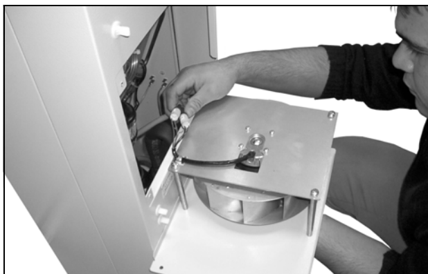
Obr. 65: Odpojení konektorů ventilátoru (1)
