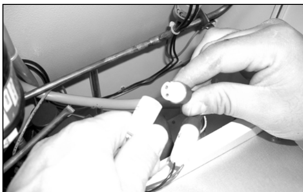
Obr. 67: Odpojení konektorů ventilátoru (3)
