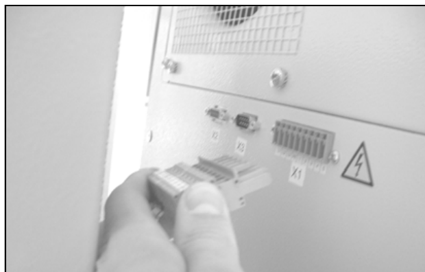
Obr. 53: Odpojení napájecího konektoru
