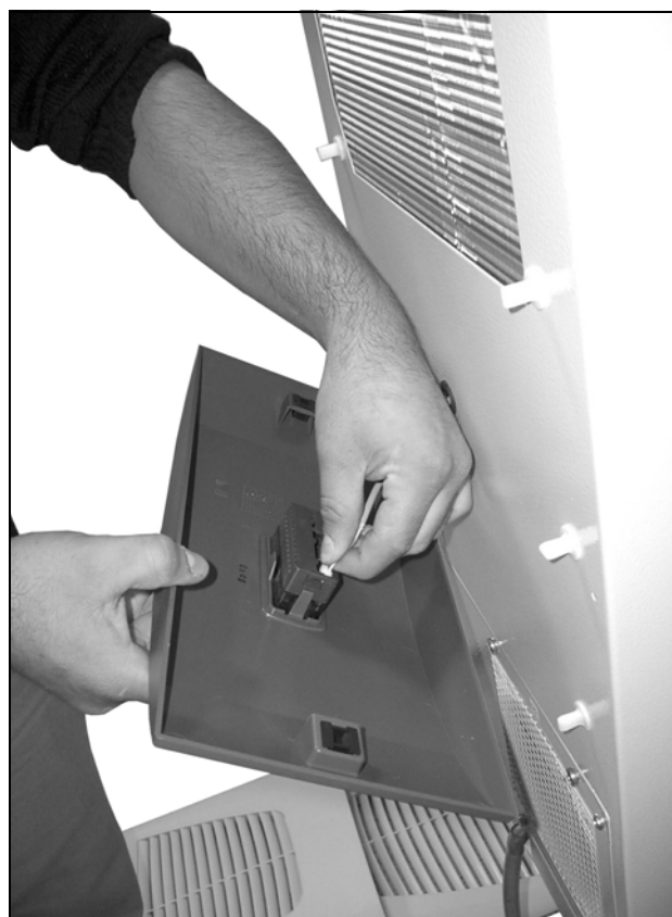
Obr. 38: Odpojení konektoru z displeje (1)
