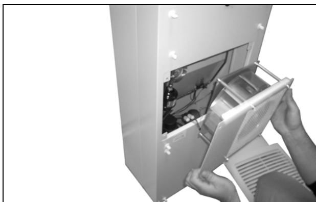
Obr. 64: Demontáž ventilátoru vnějšího okruhu
