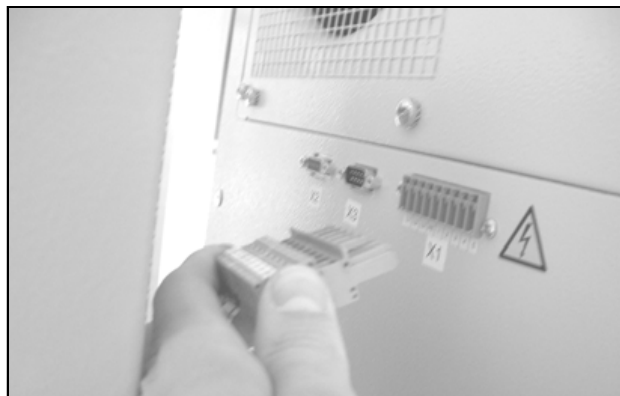
Obr. 34: Odpojení napájecího konektoru
