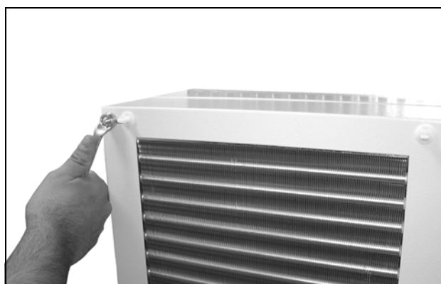
Obr. 44: Demontáž krytu (uvolnění čtyř matic)
