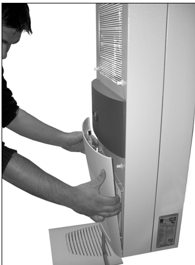
Obr. 36: Odstranění dolní lamelové mřížky
