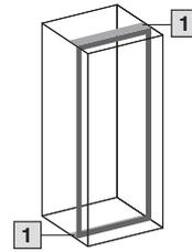
奥行き 600 mm のエンクロージャーでは、大型スウィングフレームの側面への取り付け方は、前面から取り付ける場合と同じです。スウィングフレームへの容易なアクセスを実現するために、サイドパネル用ヒンジの使用をお勧めします。
