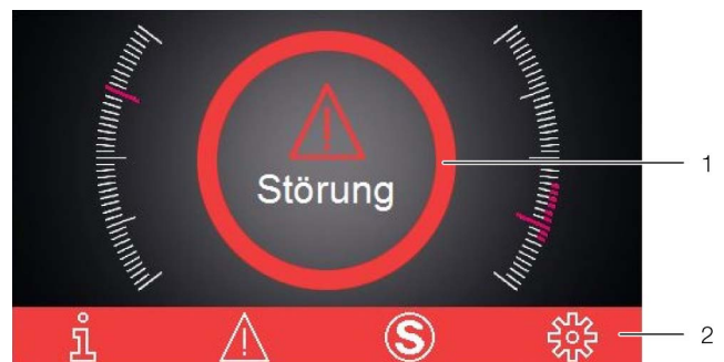
Abb. 44: Bildschirm bei Auftreten einer Störung
