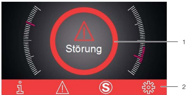
Abb. 22: Bildschirm bei Auftreten einer Störung
