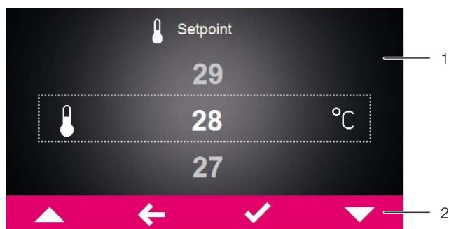
Obr. 23: Obrazovka pro změnu hodnoty parametru
