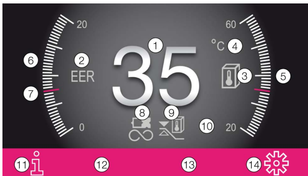
Fig. 22 : structure de l'écran de démarrage
