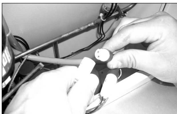
Fig. 74: Staccare i connettori del ventilatore (3)
