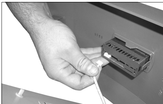
Fig. 67: Fare arretrare il cavo del display
