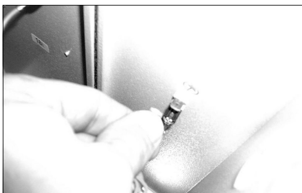
Fig. 76: Staccare il cavo di massa del ventilatore (2)
