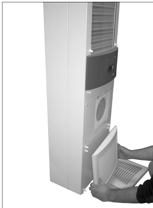
Fig. 65: Asportare la griglia di aerazione inferiore (2)
