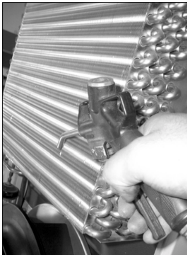
Fig. 82: Soffiare aria compressa sui tubi dello scambiatore di calore e nel vano compressore (2)
