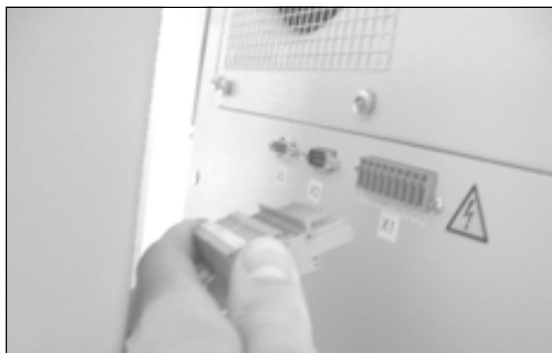
Fig. 41: Estrarre il connettore di alimentazione
