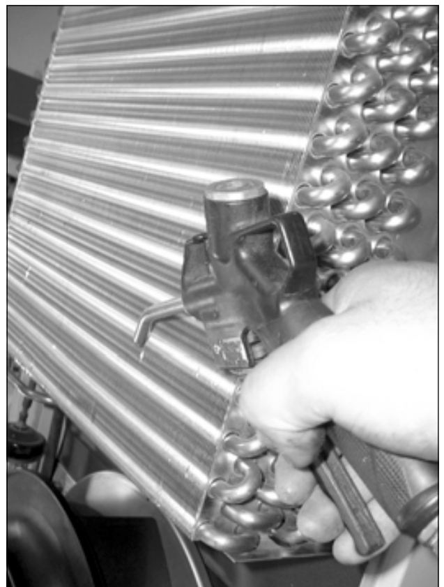
Fig. 58: Soffiare aria compressa sui tubi dello scambiatore di calore e nel vano compressore (1)
