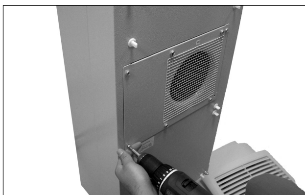
Fig. 70: Allentare le quattro viti del ventilatore del circuito esterno
