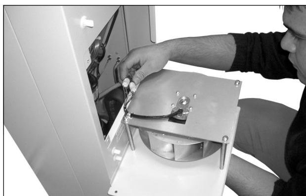
Fig. 72: Staccare i connettori del ventilatore (1)
