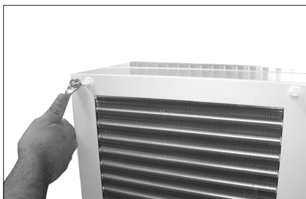
Fig. 51: Smontare la cuffia di protezione (svitare le quattro viti)
