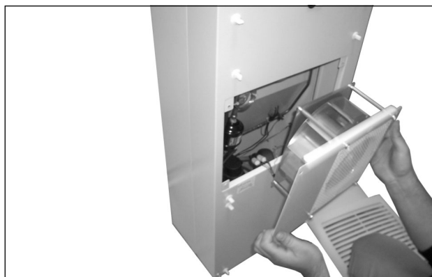
Fig. 71: Smontare il ventilatore del circuito esterno
