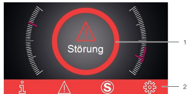
Abb. 26: Bildschirm bei Auftreten einer Störung
