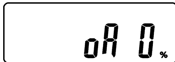
Рис. W: Настройка выходного напряжения в % от 0% до 3% или от -0% до -3%
